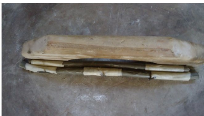
Figura 25 – Moldagem da amostra de pasta com RB em mangueira plástica de 5mm de diâmetro
