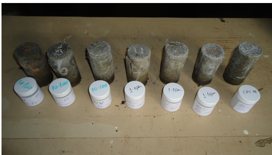
Figura 24 – Recipientes contendo testemunhos extraídos dos corpos de prova submetidos à compressão diametral
