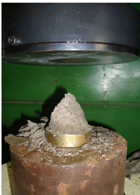
Figura 23 – Corpo de prova de argamassa rompido por compressão axial.
