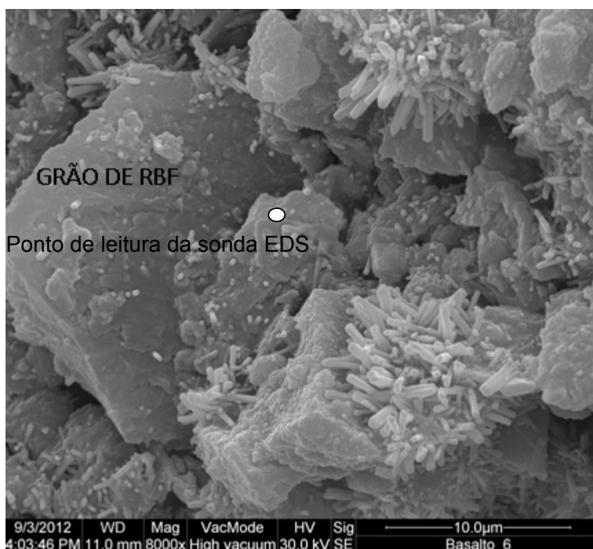
Figura 35 – Amostra de pasta de cimento CP-V ARI com 15% de RBF (Ampliação da imagem em 8.000 vezes)
