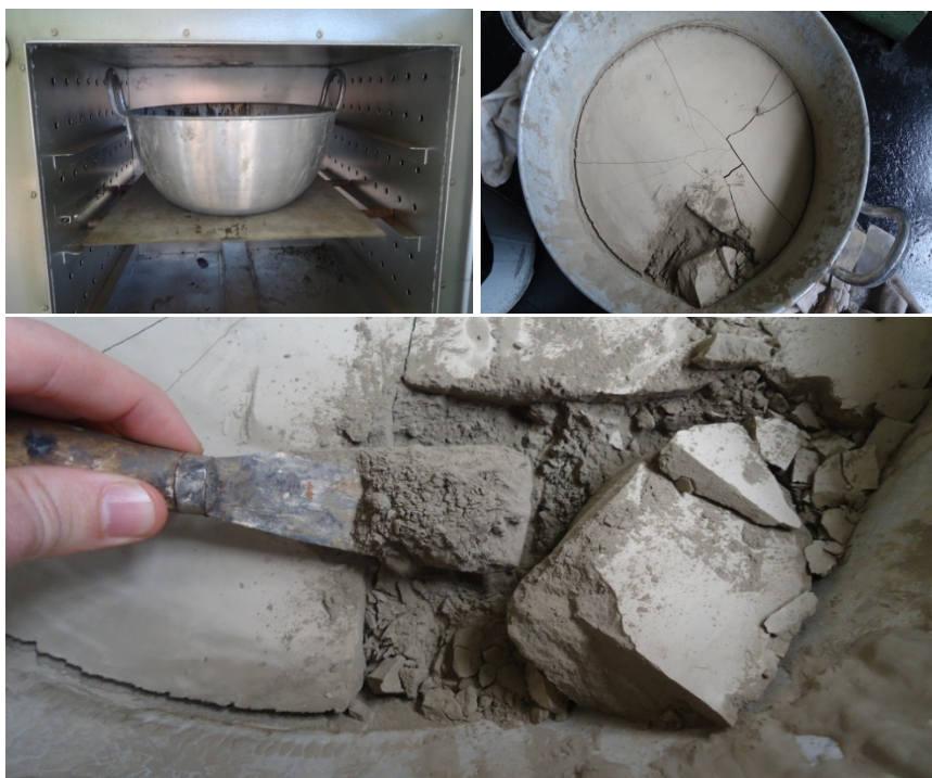
Figura 19 – Secagem do RB em estufa
