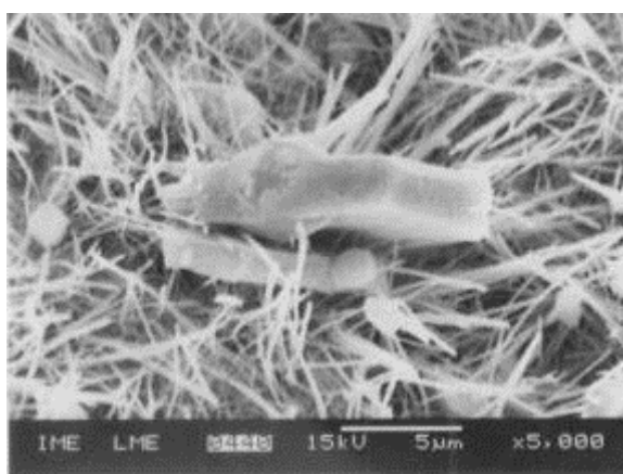
Figura 05 – Hidratação do silicato de cálcio em pasta de cimento Portland
