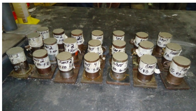
Figura 21 – Corpos de prova de argamassa moldados em formas metálicas (5x10cm)
