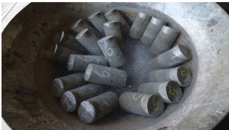
Figura 22 – Corpos de prova de argamassa após cura por imersão
