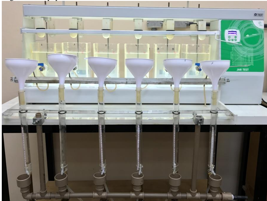
Figura 18 - Equipamento Jarteste e sistema de filtros de laboratório de areia – FLAs
