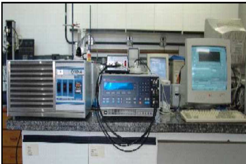
Figura 18 – Sistema completo da “língua eletrônica” mostrando sequencialmente da esquerda para a direita o banho termostaticador, o medidor de impedância e o computador
