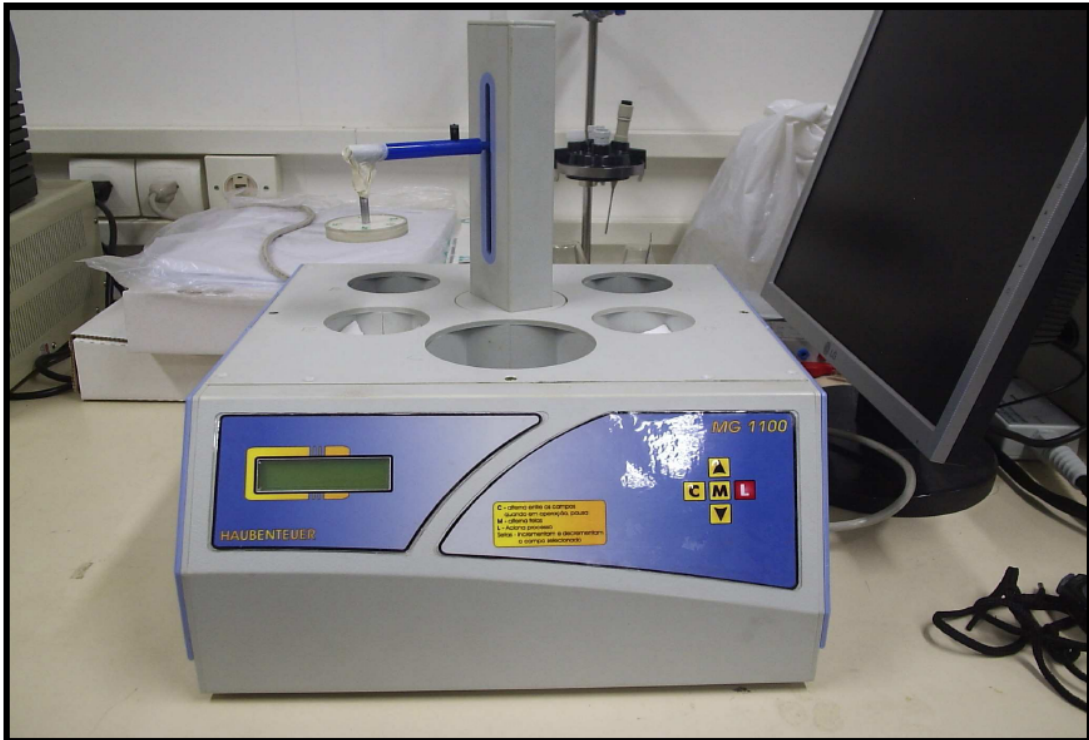
Figura 14 – Sistema automático de deposição por automontagem dos filmes poliméricos para os sensores da “língua eletrônica”
