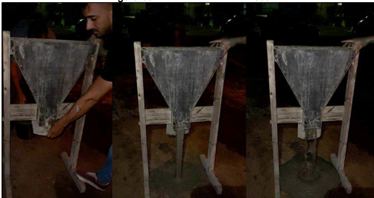
Figura 65 – Ensaio de funil-V in loco
