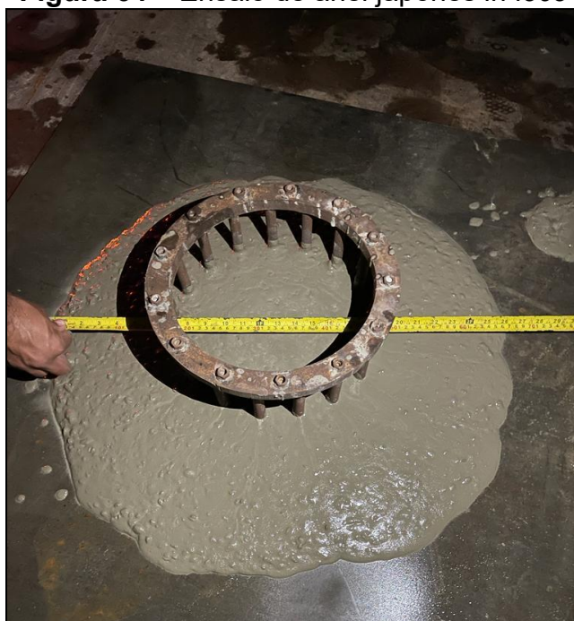
Figura 64 – Ensaio de anel japonês in loco
