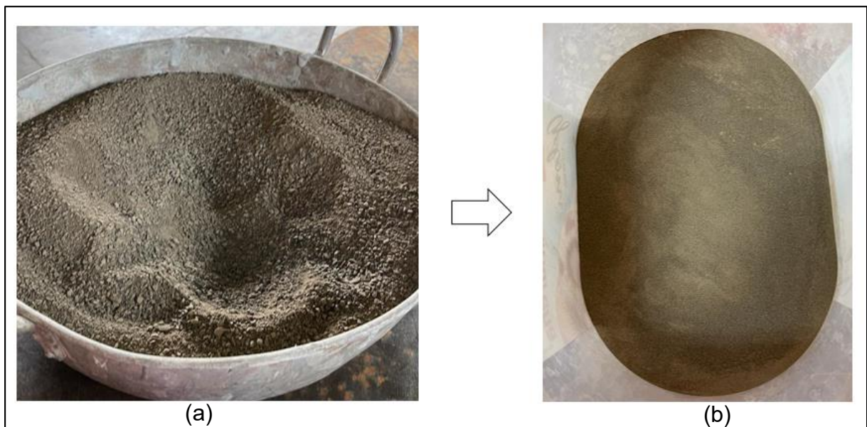
Figura 19 – Material retido na peneira de número 200
