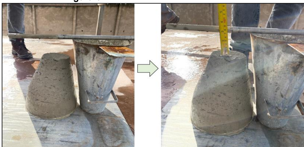
Figura 61 – 1º abatimento do concreto analisado
