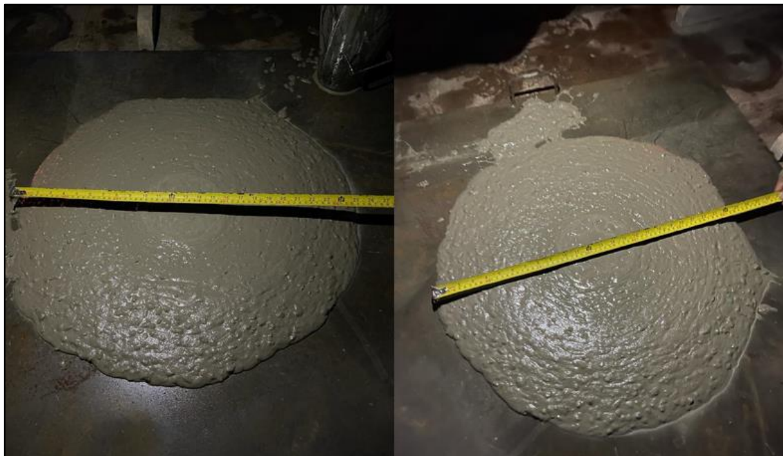
Figura 63 – Ensaio de slump flow in loco
