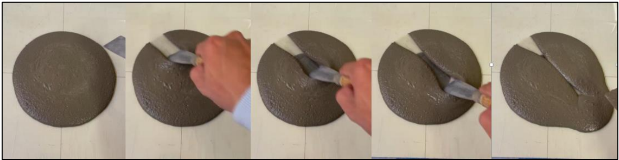
Figura 43 - T_{\text{risco}} na argamassa 3_ARG100/0,6
