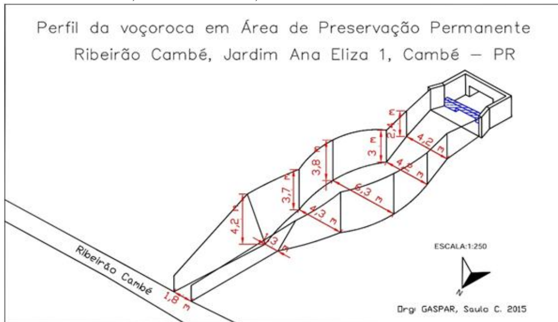
Figura 22 - Ponto 1, Perfil da voçoroca em Área de Preservação Permanente Ribeirão Cambé, Jardim Ana Eliza 1, Cambé - PR
