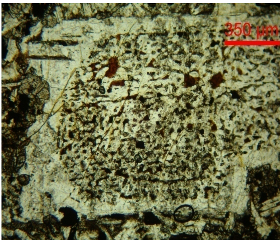
Figura 18 – Fotomicrografia exibindo fenocristal de plagioclásio poiquilítico, contendo inclusões de clinopiroxênio; secundariamente material vítreo alterado e bordas praticamente sem inclusões evidenciando zoneamento. Imagem obtida com luz polarizada e polarizadores descruzados (Horizonte Cr – P2).
