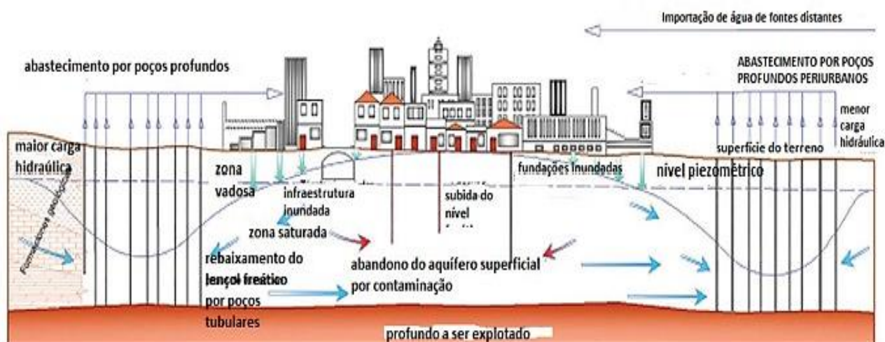
Figura 9 - Alterações na profundidade e na distância dos poços tubulares durante o crescimento da cidade
