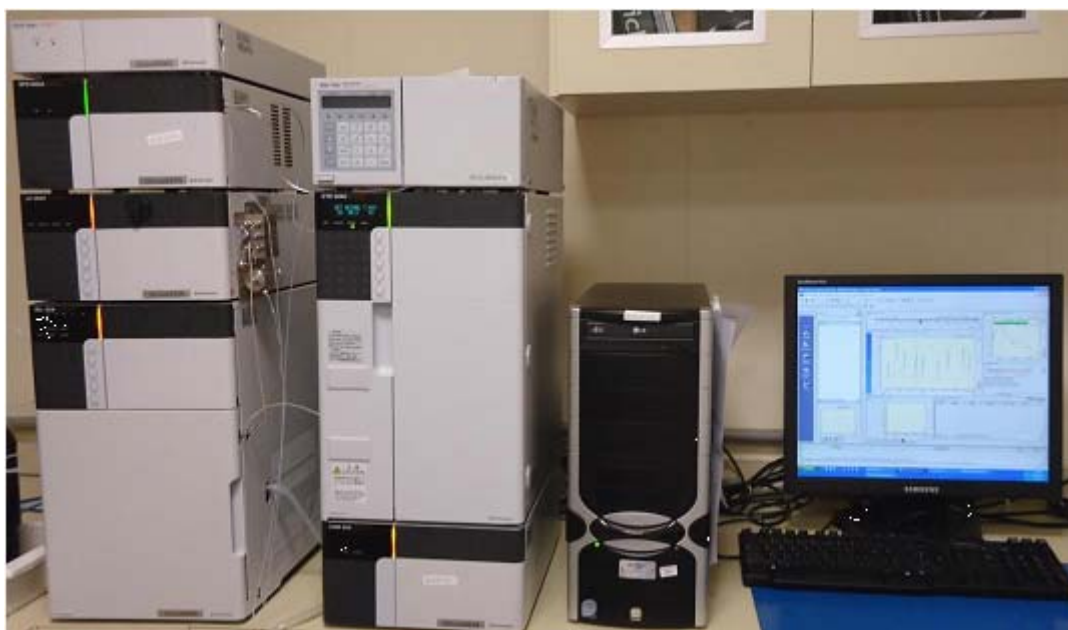
Figura 4.2 – Imagem do equipamento do HPLC (High Performance Liquid Chromatography) utilizado para identificação e quantificação de compostos secundários de extratos vegetais .
