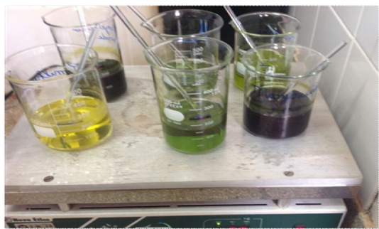
Figura 11 – Secagem dos extratos dos antioxidantes naturais à 60 °C em uma chapa aquecedora.
