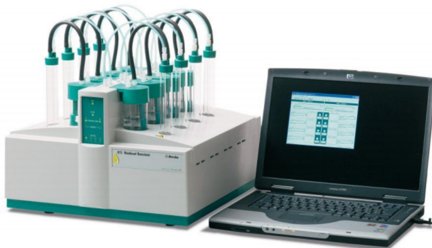
Figura 10 – Esquema de funcionamento do aparelho Rancimat.
