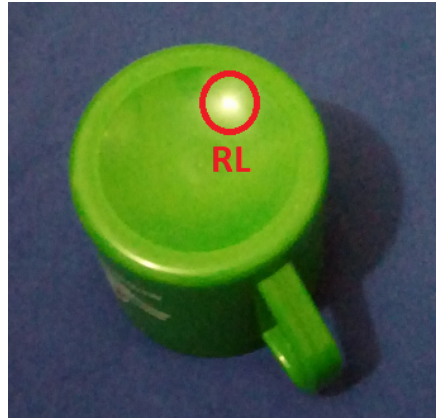
Figura 1 – Exemplo de saturação do pixel devido à alta intensidade de luminosidade.
