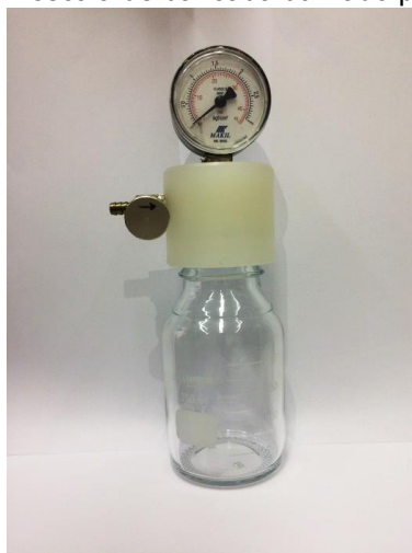
Figura 9 – Reator em escala de bancada utilizado para o ensaio de BMP
