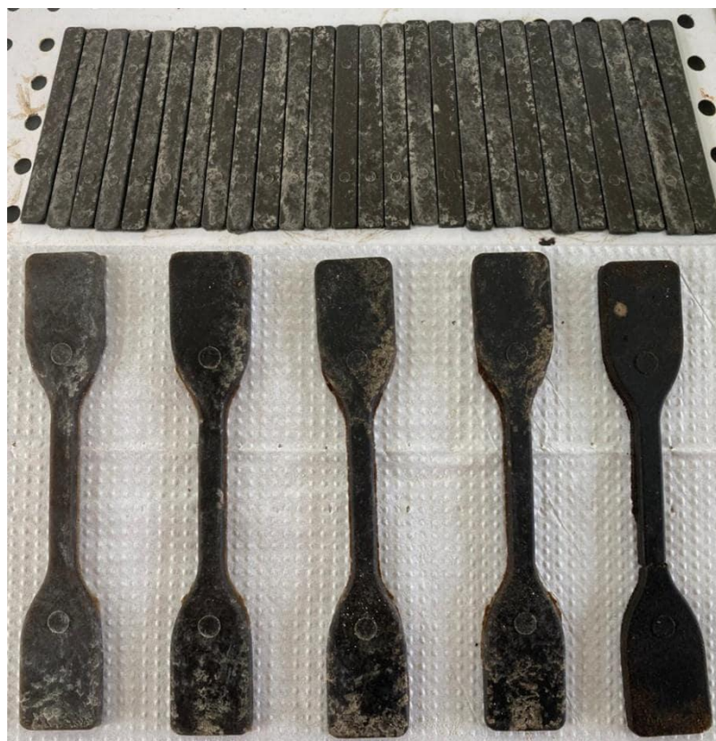
Figura 12 - Corpos de prova produzidos pela injeção termoplástica.
