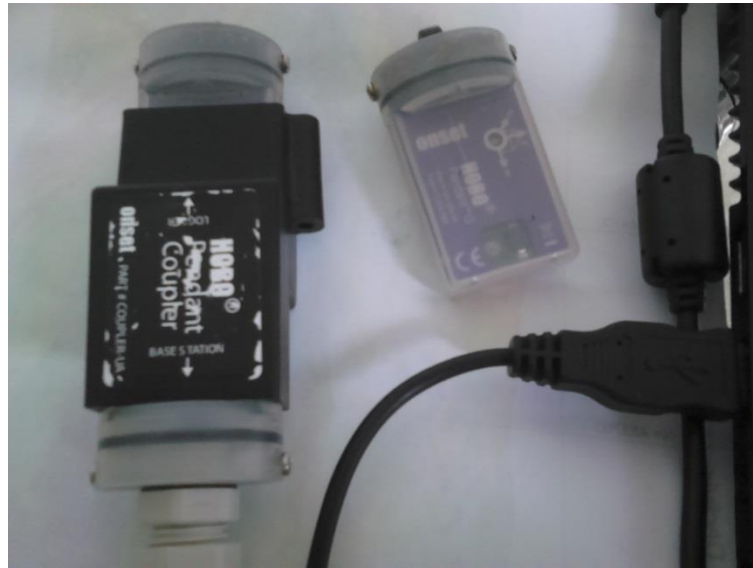
Figura 2 - Data logger e cabo conector para o download das informações
