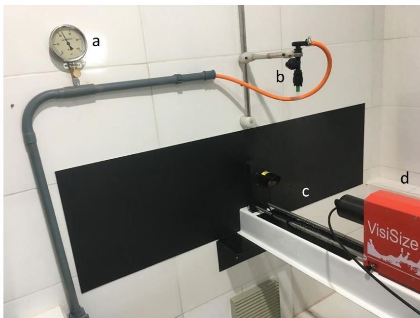
Figura 3.3 - Esquema da área de coleta de dados: manômetro (a); bico de pulverização (b); área de leitura (c); analisador de partícula (d).
