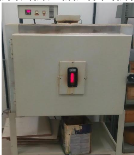
Figura 3.6. Mufla elétrica utilizada nos ensaios de aquecimento.
