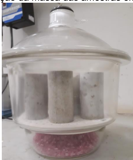
Figura 3.4. Estabilização da massa das amostras em dessecador de vidro.
