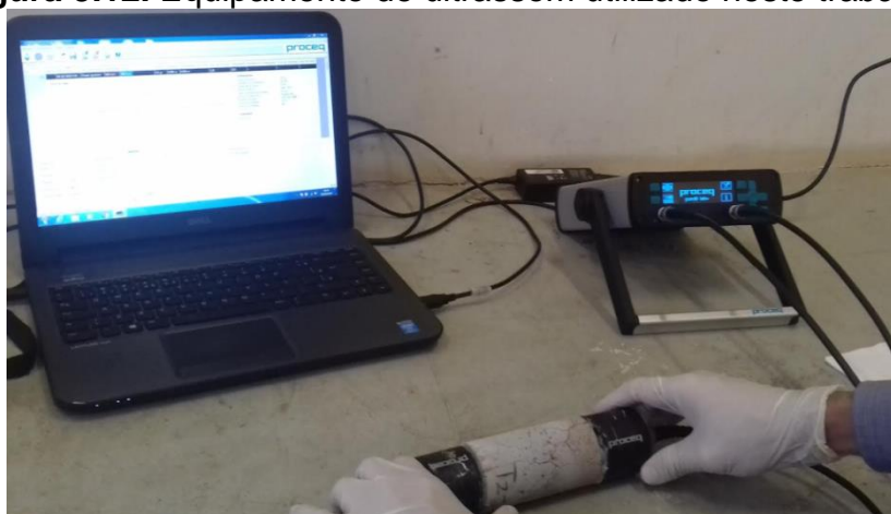
Figura 3.12. Equipamento de ultrassom utilizado neste trabalho.
