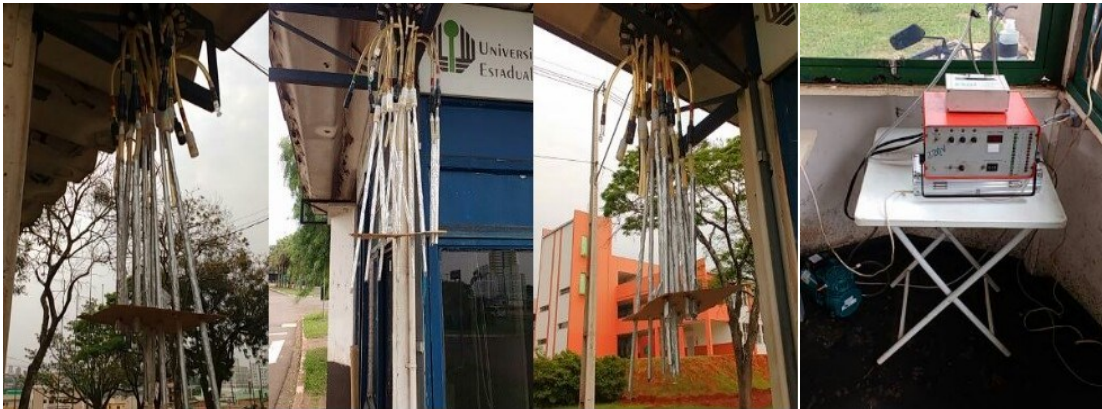
Figura 5 – Amostradores denuder tubular e anular no amostrador sequencial automático. Caixa de comando e bomba de diafragma.
