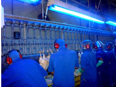
Figura 2 – Sistema convencional de suspensão dos frangos em nóreas.
