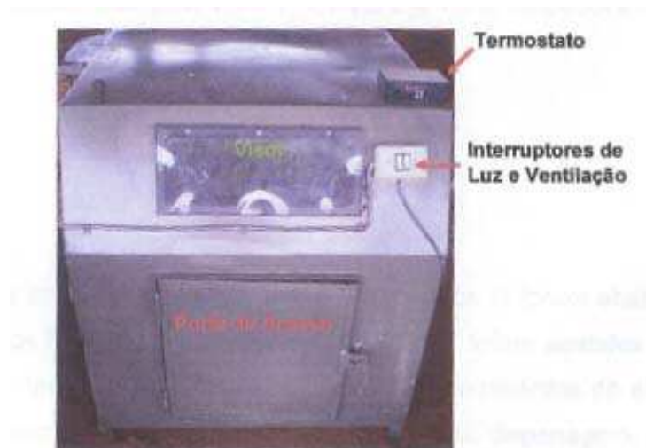
Figura 14 – Câmara construída para a aplicação de estresse térmico (35°C/1h) em frangos.
