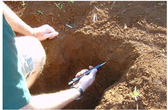
Foto 9 – Uso do Penetrômetro de Bolso para Solos na marcação de 10cm. Foto: Parizoto, G.M. (2007).
