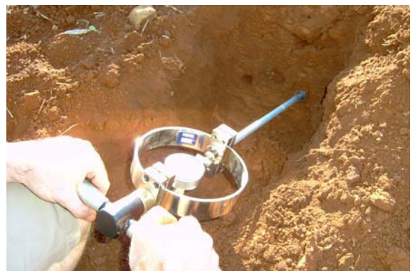
Foto 9 – Uso do Penetrômetro de Bolso para Solos na marcação de 10cm. Foto: Parizoto, G.M. (2007).
