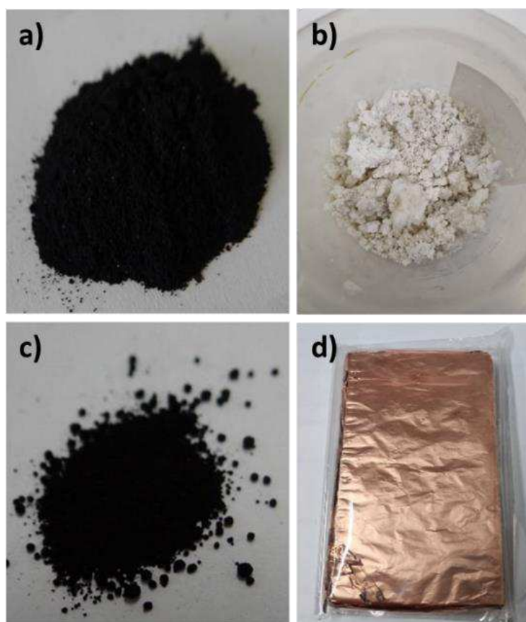
Figura 13. Pó do catodo (a), o composto de coloração branca recuperado após a dissolução seletiva do Al com NaOH (b), o pó do anodo (c) e coletor metálico de Cobre (d)
