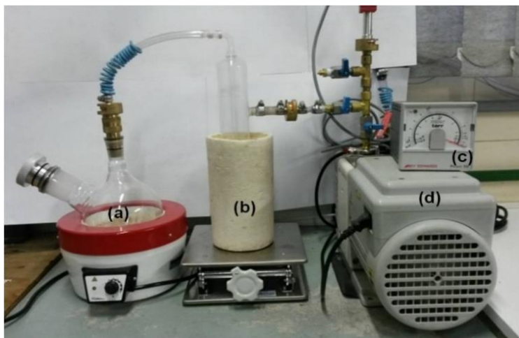
Figura 6 - Sistema para extração do eletrólito à vácuo: (a) balão contendo o “rocambole” de eletrodos, (b) armadilha de nitrogênio, (c) medidor de vácuo e (d) bomba de vácuo mecânica
