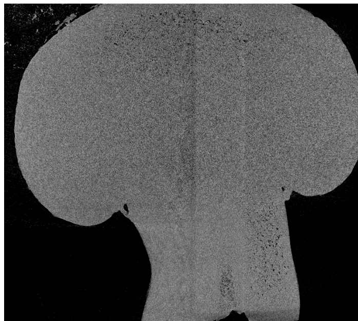
Figura 13 - ( \mu CT) Microtomografia do interior do cogumelo pré-cozido (SkyScan 1173, 1 pixel = 12,5 \mu m).
