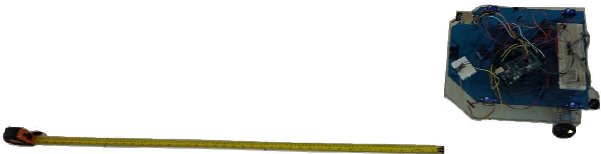
Figura 5.25: Imagem do robô no teste da reta.
