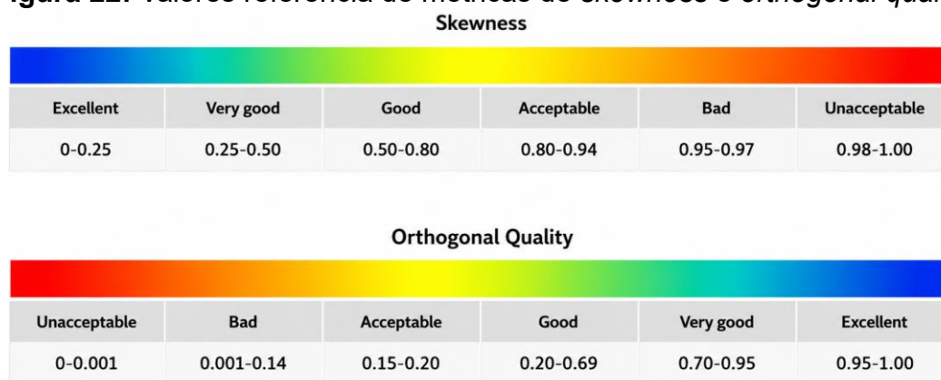
Figura 22: Valores referência de métricas de skewness e orthogonal quality .
