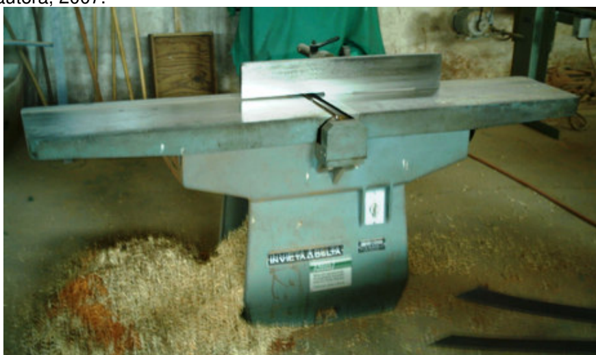
Foto 39: Desempenadeira. Equipamento utilizado para desempenar a madeira e para fazer o acabamento nas lâminas (fórmica). Fabricado pelo grupo industrial Invicta Vigorelli Metalúrgica Ltda, Limeira-SP.
