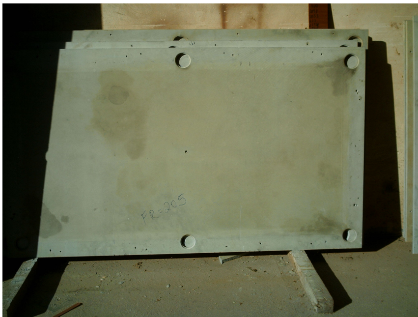
Foto 29: Placas de ardósia para mesas de bilhar. Após serem cobertas pelo tecido verde, formarão o campo (tampão) da mesa. Essa peça é fixada com parafusos na base da mesa. Fonte: A autora, 2007.
