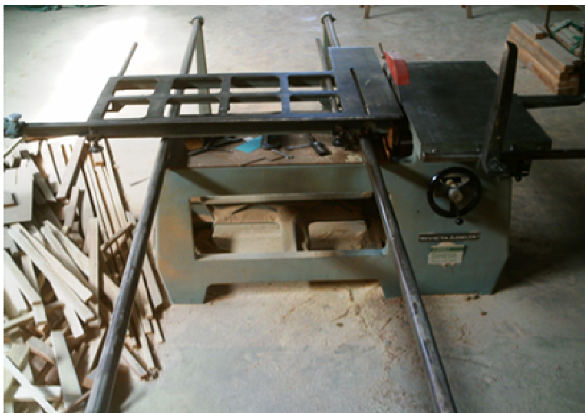
Foto 36: Serra Circular com mesa móvel. Equipamento utilizado para serrar todas as madeiras e compensados em linhas retas. Fabricado pelo grupo industrial Invicta Vigorelli Metalúrgica Ltda, Limeira-SP
