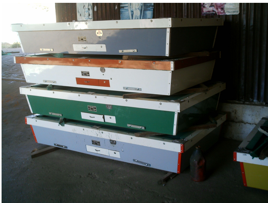
Foto 34: Mesas para bilhar para serem reformadas. Por se tratar de uma produção similar ao artesanal, cada mesa para bilhar acaba tendo pequenas diferenças em relação ao tamanho e encaixe das peças, sendo assim não pode ocorrer a troca de seus componentes (quadro, ardósia e tabelas principalmente). Para evitar tal problema, essas peças são numeradas quando a mesa é desmontada.
