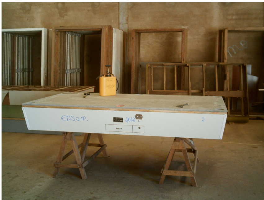
Foto 30: Mesa para bilhar já revestida com a fórmica e com a ardósia fixada na parte superior. Observa-se em cima da mesma um líquido utilizado para combater infestação de cupins na madeira. Ao fundo vemos uma peça que irá compor a mesa, denominada “quadro” pelos marceneiros. Essa peça juntamente com a tabela, será fixada na parte superior da mesa. A função da peça denominada “quadro” é fixar a tabela e dar o acabamento na mesa. A tabela é composta por borracha e madeira e tem por função absorver o impacto da bola e projetar a mesma no lado oposto. Fonte: A autora, 2007.
