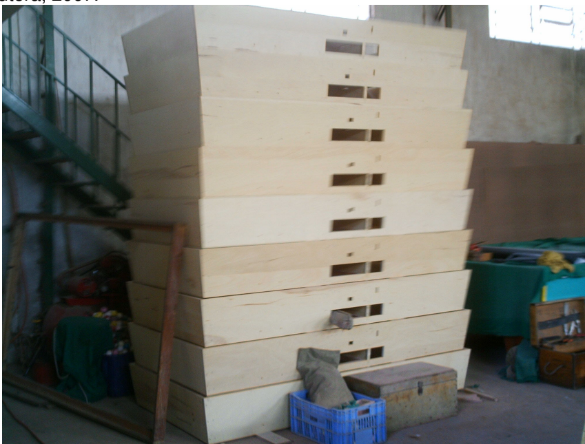
Foto 28: Bases das mesas para bilhar. Essas bases já passaram pela fase de lixamento e estão prontas para receberem as demais peças, como a ardósia e os laminados (fórmicas).
