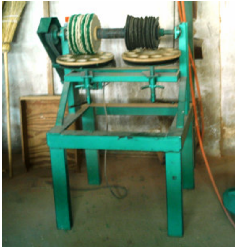
Foto 42: Equipamento especial para polir bolas de mesas para bilhar. Essa máquina serve apenas para dar brilho nas bolas.
