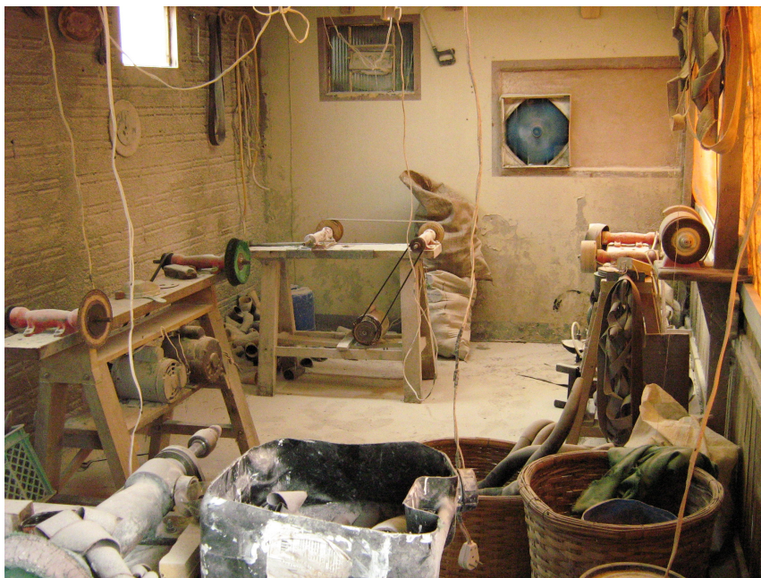
Foto 19: Vista parcial do local de fabricação dos objetos como copo, garrafas e berrantes. Observa-se que os equipamentos foram adaptados objetivando facilitar o trabalho na produção de cada peça.
