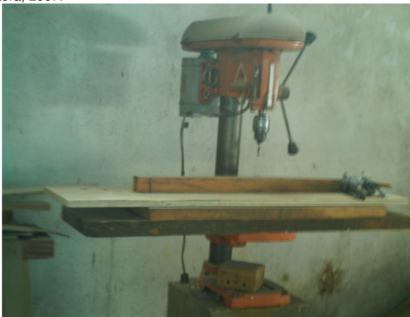
Foto 43: Em destaque uma Furadeira Vertical. Equipamento utilizado para perfurar a madeira no sentido vertical.
