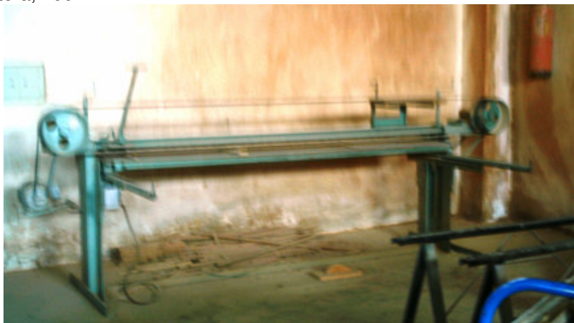
Foto 41: Em destaque uma Lixadeira de fita com disco. Equipamento utilizado para lixar qualquer tipo de madeira.
