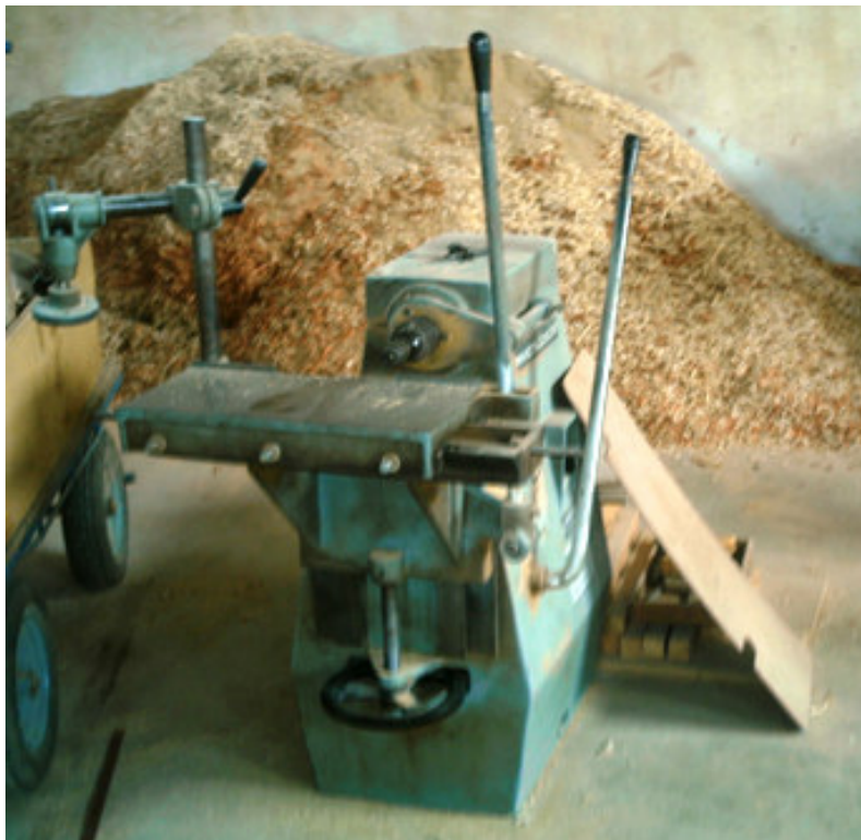
Foto 40: Furadeira Horizontal. Equipamento utilizado para perfurar a madeira e compensados durante a fabricação das mesas. Dotada de um acessório específico (ponta) ela faz o encaixe da ponta do taco durante a reforma. Fabricado pelo grupo industrial Invicta Vigorelli Metalúrgica Ltda, Limeira-SP.
