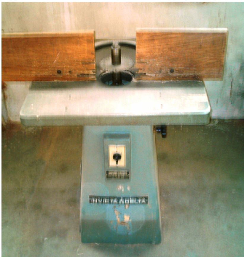
Foto 38: Vista parcial de uma Tupia. Esse equipamento é utilizado para entalhar a madeira e para o acabamento lateral. Fabricado pelo grupo industrial Invicta Vigorelli Metalúrgica Ltda, Limeira-SP.
