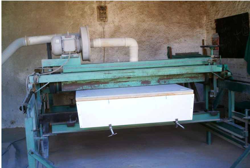
Foto 31: Vista parcial do equipamento utilizado no acabamento da ardósia. Nessa etapa a ardósia já fixada na base da mesa passa pelo processo de lixamento, para corrigir as possíveis irregularidades presentes na mesma.
