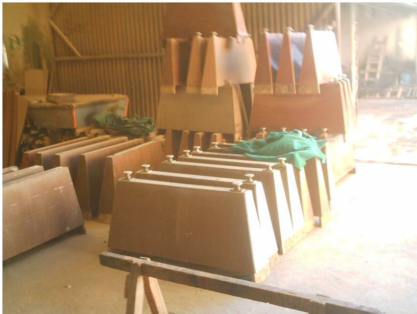
Foto 32: Vista parcial dos pés da mesa para bilhar. Cada peça possui um acessório de alumínio que tem por função adequar a mesa às irregularidades do piso no estabelecimento comercial. Esse acessório contribui para que a mesa fique nivelada.
