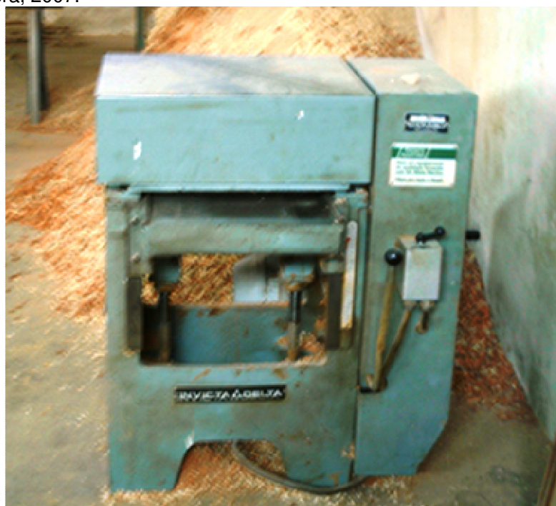
Foto 37: Vista parcial de uma Plaina Desengrossadeira. Equipamento utilizado para obter espessuras mais finas das madeiras maciças. Fabricado pelo grupo industrial Invicta Vigorelli Metalúrgica Ltda, Limeira-SP.
