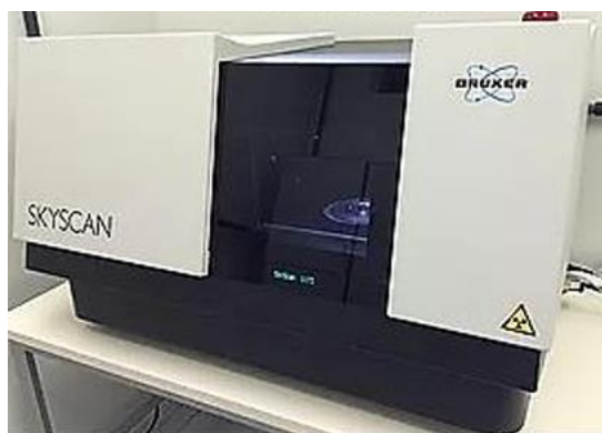
Figura 24 – Microtomógrafo usado para o ensaio de Micro-CT.
