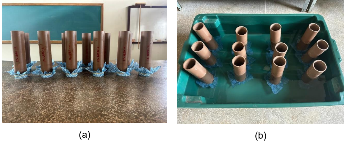
Figura 36 – (a) Conjunto corpo de prova com o Perfex® e (b) processo de saturação.
