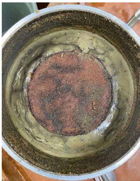
Figura 42 – Exemplo de manchas escuras no topo do corpo de prova após a percolação dos fluidos contaminantes.
