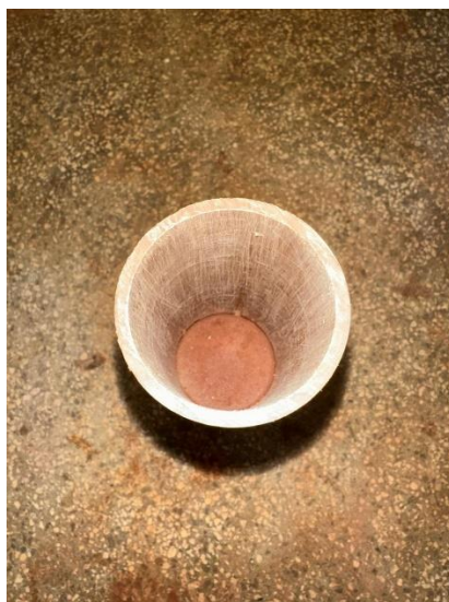
Figura 35 – Amostra compactada para ensaios de difusão.
