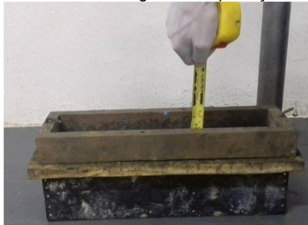
Figura 43- Medição da altura final do concreto permeável após compactação para cálculo da energia de compactação.
