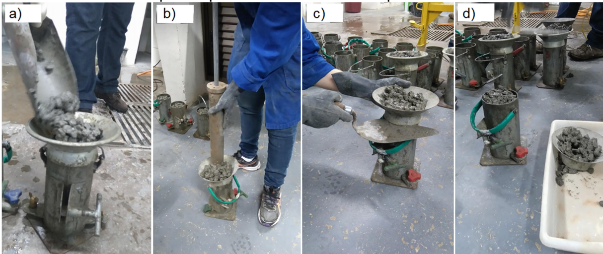
Figura 37- Procedimento de moldagem em volume dos corpos de prova cilíndricos: a) enchimento do molde; b) compactação; c) rasamento; d) corpo de prova no molde pronto para ensaio de massa específica.
