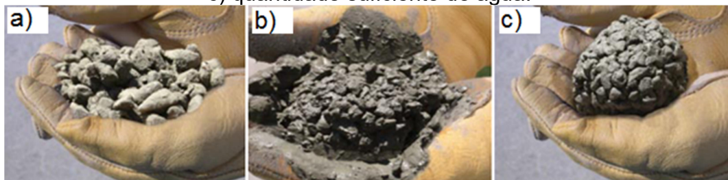
Figura 1- Concreto permeável com: a) pouca água; b) excesso de água; c) quantidade suficiente de água.
