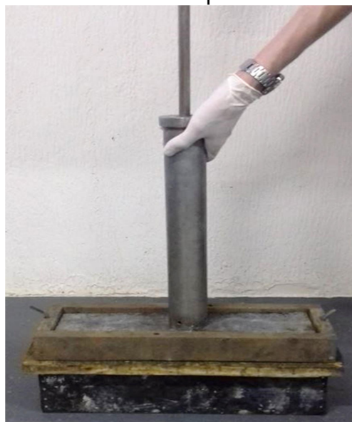
Figura 44- Compactação dos corpos de prova prismático com aplicação dos golpes no centro da chapa metálica.
