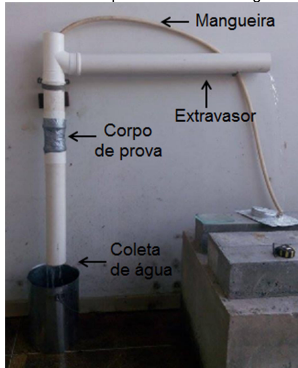
Figura 34- Ensaio no permeâmetro de carga constante.
