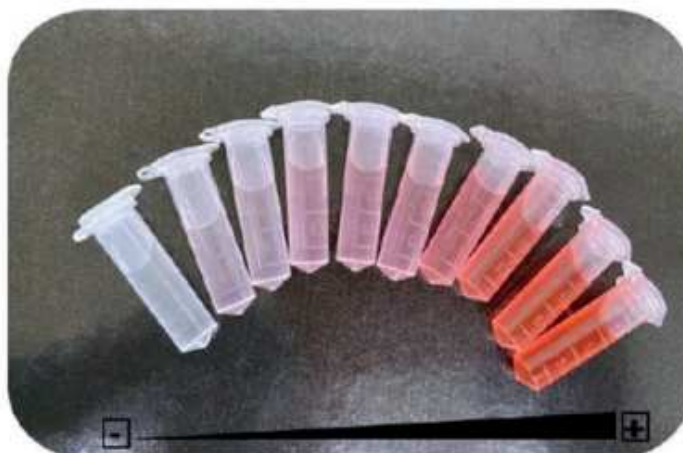
Figura 7. Curva de calibração para quantificação, por espectrofotometria, do ácido indol-3-acético produzido por bactérias promotoras do crescimento de plantas. A concentração está indicada da esquerda (-), menos concentrada, para a direita (+), ou mais concentrada.
