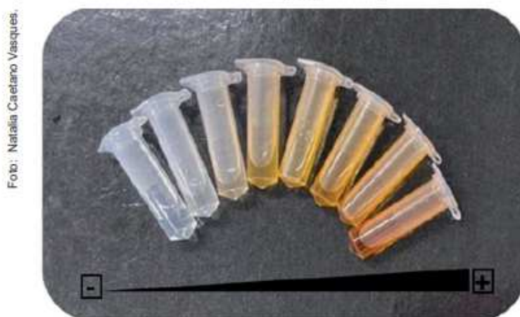
Figura 11. Curva de calibração utilizando glicose para quantificação, por espectrofotometria, da concentração de exopolissacarídeos produzidos por bactérias promotoras do crescimento de plantas. A concentração está indicada da esquerda (-), menos concentrada para a direita (+), mais concentrada.
