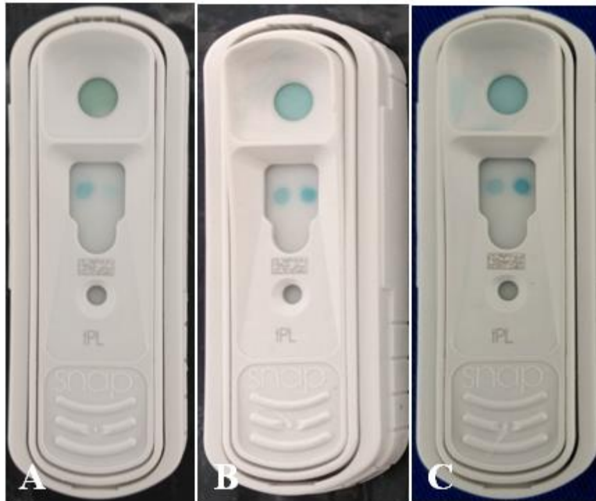
FIGURA 1. Interpretação do Snap Test fPLI (IDEXX Laboratories®). A. Concentração normal de lipase. Ponto controle (esquerda) com cor mais intensa que o ponto da amostra (direita). B. Concentração anormal alta de lipase. Ponto controle com a intensidade da cor igual ao ponto da amostra. C. Concentração anormal muito alta de lipase. Ponto da amostra com cor muito mais intensa que o ponto controle. (Fonte: o autor)
