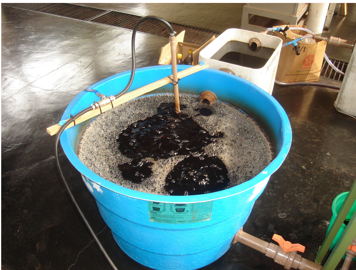
Tanque de aeração e decantador do sistema 1.
