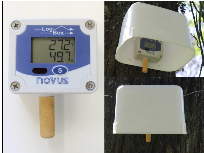
FIGURA 3. Registrador eletrônico de temperatura e umidade (Novus, modelo LOG BOX-RHT-LCD) instalado no no Parque Estadual da Mata dos Godoy, Londrina, Paraná, sul do Brasil. Registradores instalados com ponteira de cobre sobre o sensor e protegido por uma cúpula plástica que não isola o sensor do ambiente. Fotos: Guilherme Willrich.
