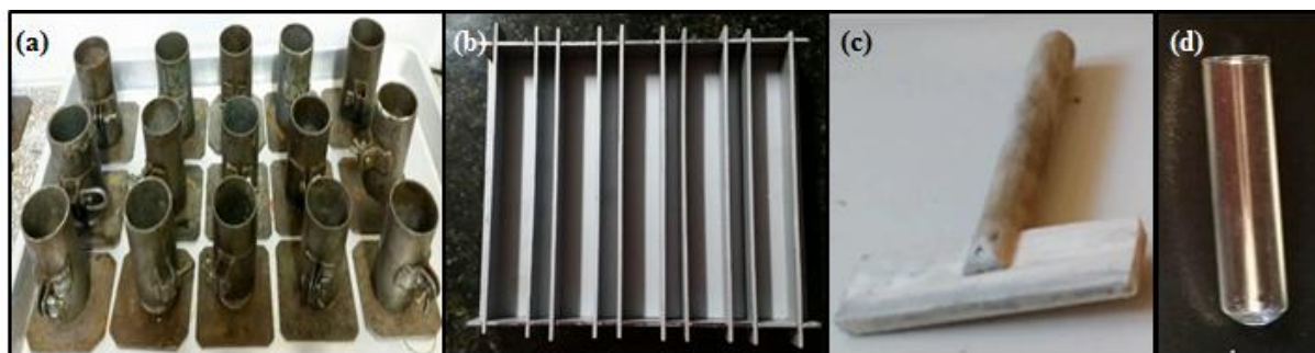
Figura 24– Formas utilizadas na 2ª Campanha Experimental, onde em (a) estão apresentados os corpos de prova cilíndricos, de 50x100mm; em (b) os prismáticos, de 10x10x130 mm; em (c) o soquete utilizado para a compactação dos corpos de prova prismáticos e em (d) os tubos de ensaio utilizados para moldagem das amostras para termogravimetria.
