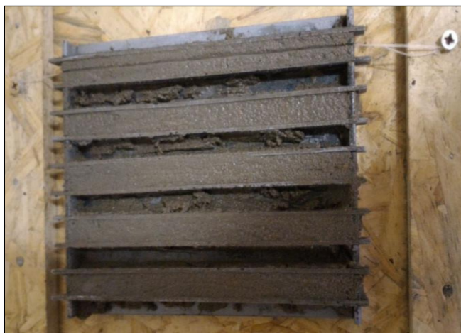
Figura 25 – Corpos de prova prismáticos moldadas com a trinca induzida
