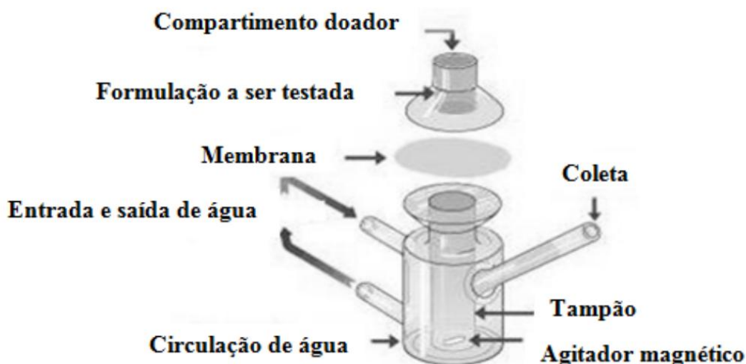
Figura 8. Representação esquemática da Célula de Franz. Fonte: SILVA et. al., 2010.
