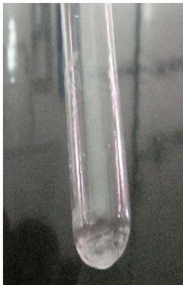
Figura 25 – Aspecto esbranquiçado e compacto da 1 a e 2 a fração de eluição com metanol da CIA confeccionada.
