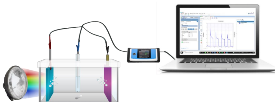
Figura 14 - Célula fotoeletroquímica conectada ao potenciostato e lâmpada Xênon como fonte de radiação.
