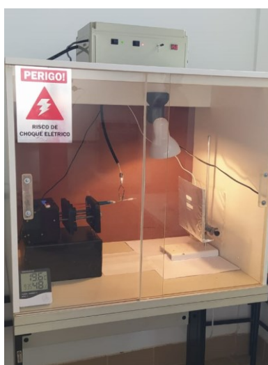
Figura 16 - Equipamento de eletrofiação (E-Spin Tech) utilizado.
