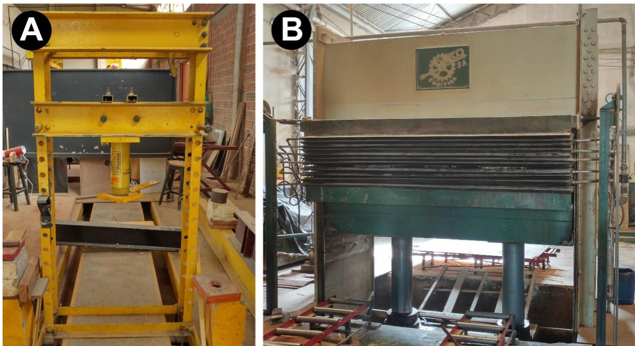
Figura 14: a) prensa hidráulica do modelo ENERPAC IPE-3060 e b) prensa hidráulica da marca OMACO
