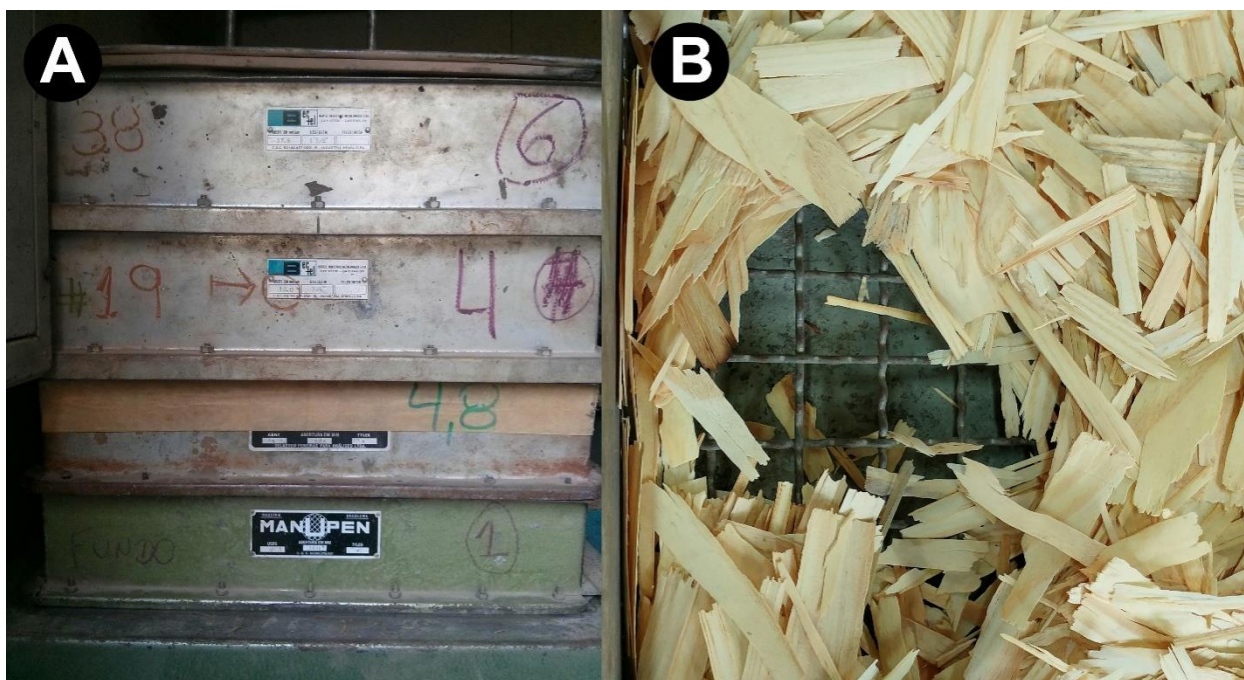
Figura 19: a) peneira vibratória e b) strands de pinus na bandeja de malha 19 mm da peneira
