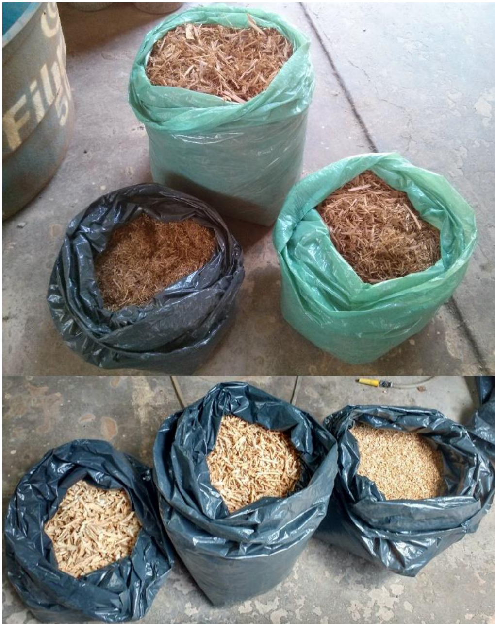
Figura 22: Partículas de casca de Eucalyptus grandis , Strands e Maravalhas de Pinus spp.
