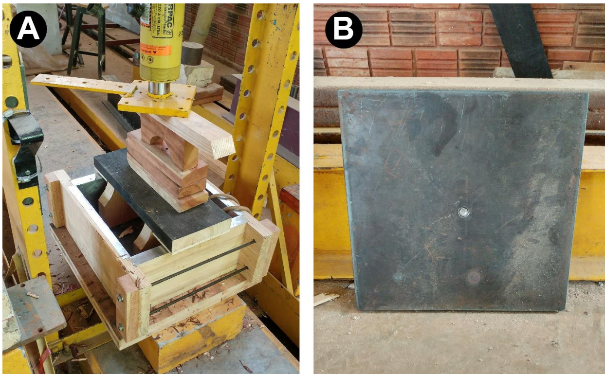
Figura 29: a) Pré-prensagem e b) Cabeça de prensa em chapa de aço.
