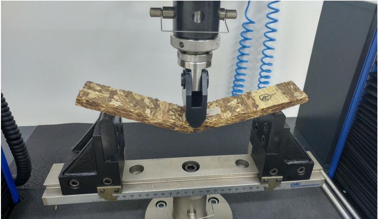
Figura 37: CP na posição de ensaio e após sua ruptura.
