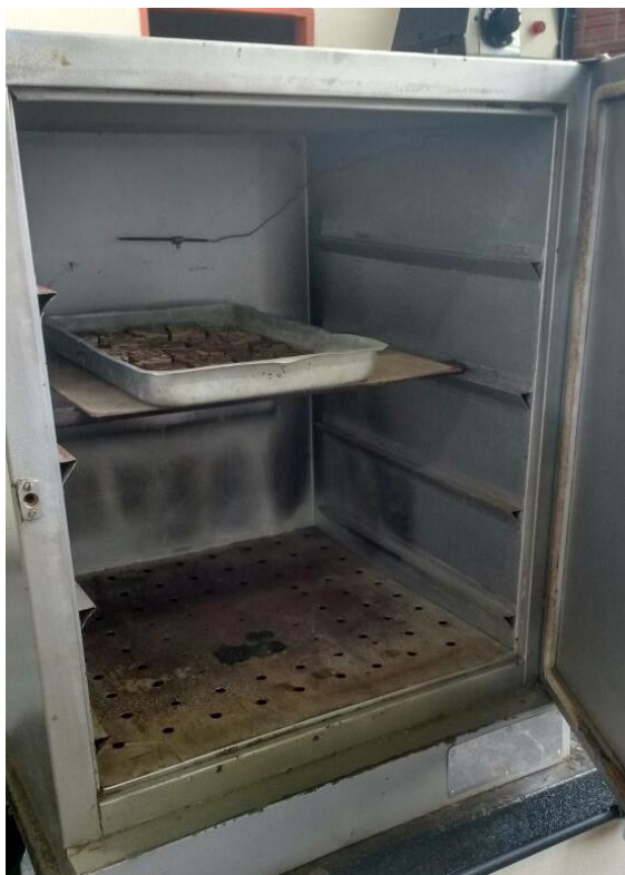
Figura 34: Estufa ventilada para realização de ensaio de Teor de umidade.
