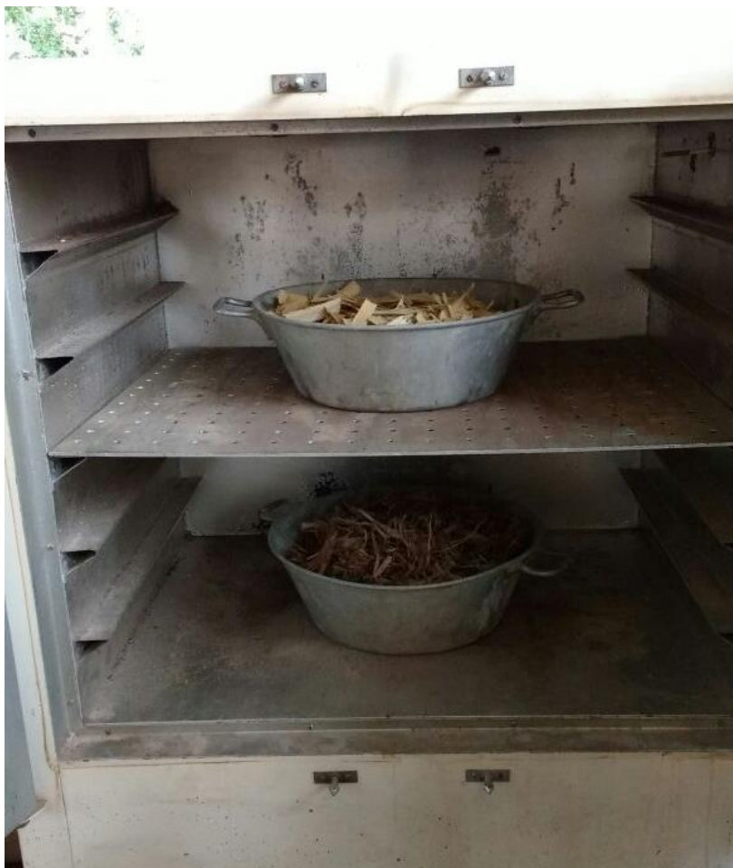
Figura 24: Matérias-primas dispostas em bandejas e em estufa ventilada.
