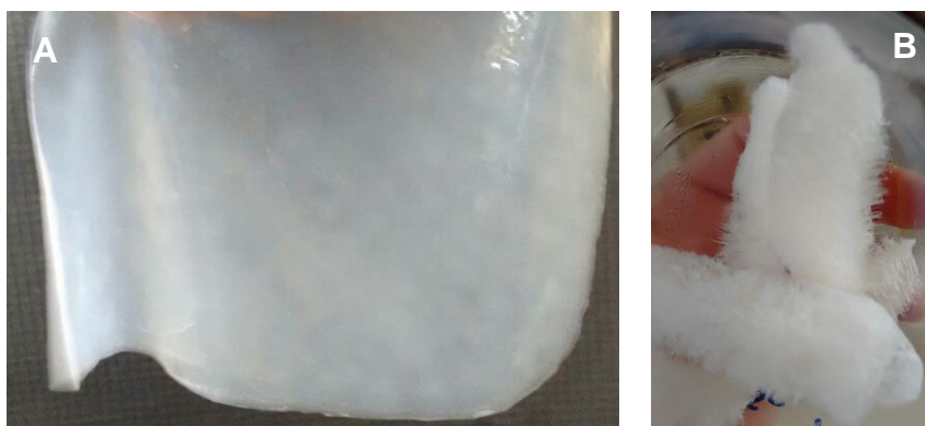
Figura 9. A: Membrana de Celulose produzida pelo processo de Fermentação. B: Nanocristais de celulose Nativa liofilizada obtido através da Reação de Hidrólise.
