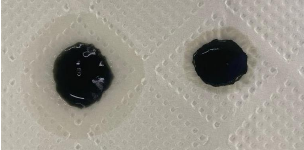
Figura 10 - Comparação em relação a sedimentação entre Padrão comercial x protótipo LABIM-B3F008
