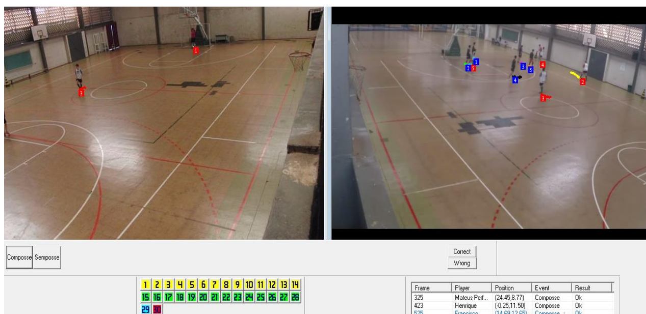
Figura 8 - Interface do software DVideo para a identificação das ações técnicas realizadas pelos jogadores e outros eventos que ocorrem durante a partida.
