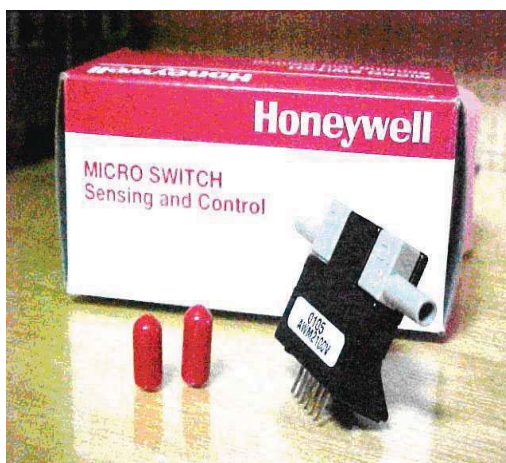
Figura 3.4: Transdutor de flux de ar usado no protótipo.
