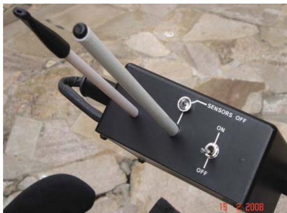
Figura 3.3: Módulo de condução: duto para sopro e sucção à esquerda e haste para desligar os sensores à direita.
