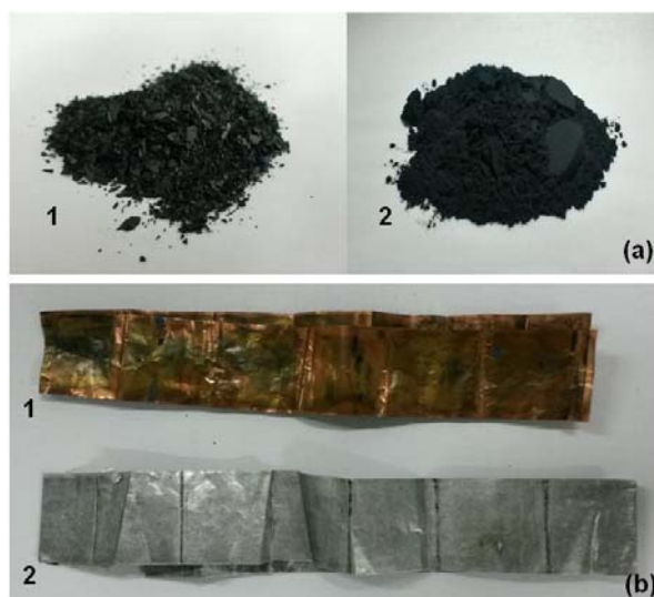
Figura 22 – Representação (a) dos pós extraídos dos eletrodos de baterias descartadas de íon-lítio e (b) seus coletores metálicos após a extração do material eletroativo
