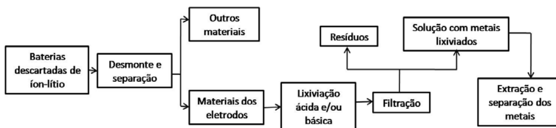
Figura 4 – Esquema do fluxo de um processo de recuperação dos metais presentes nas baterias de íon-lítio
