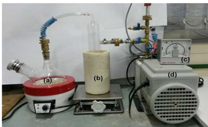
Figura 10 – Sistema para extração do eletrólito à vácuo, do Laboratório FILMAT: (a) balão volumétrico, (b) armadilha de nitrogênio, (c) medidor de vácuo e (d) bomba de vácuo mecânica
