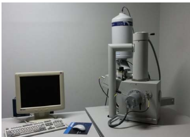
Figura 15 – Microscópio Eletrônico de Varredura do Laboratório LMEM usado na realização das medidas das amostras sem tratamento térmico
