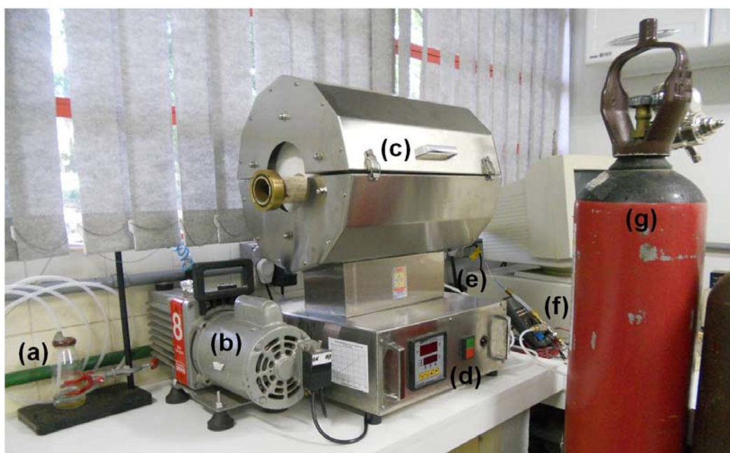
Figura 13 – Montagem experimental para o tratamento térmico dos pós, composto por (a) borbulhador, (b) bomba de vácuo mecânica, (c) forno tubular, (d) programador digital do forno, (e) fio do termopar, (f) válvula controladora de gás e (g) cilindro de gás oxigênio
