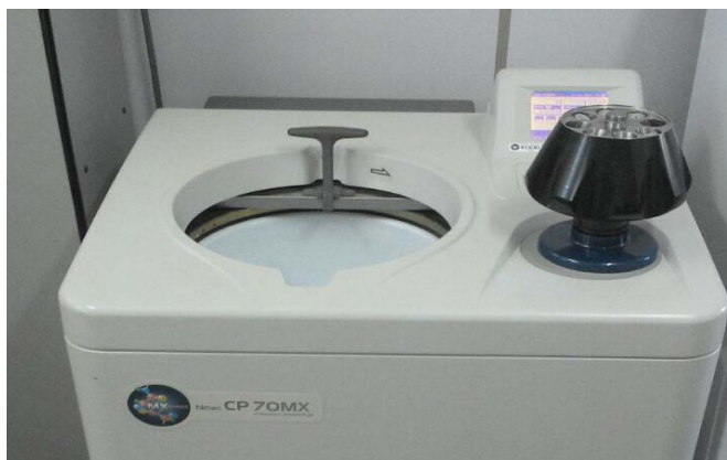
Figura 12 – Ultracentrífuga usada para separação do pó do solvente NMP
