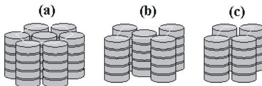
Figura 2-15. Arranjos moleculares das fases colunares: (a) hexagonal; (b) retangular; (c) oblíqua.
