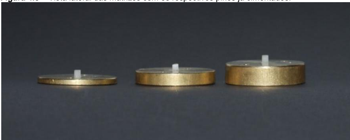
Figura 4.8 – Vista lateral das matrizes com os respectivos pinos já cimentados.
