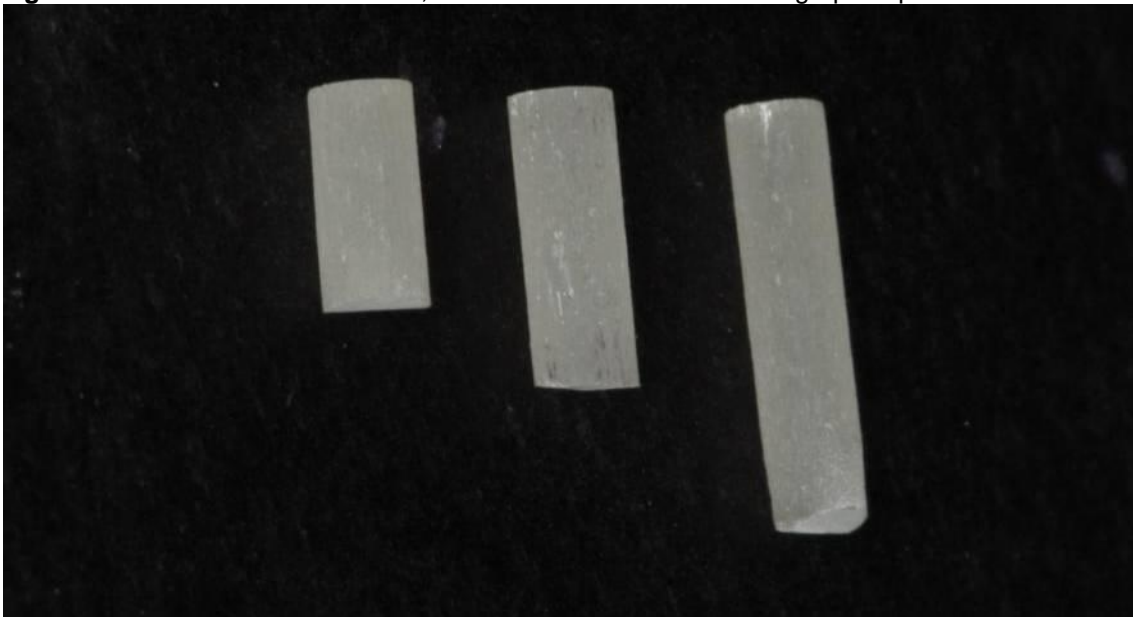
Figura 4.6 – Pinos de fibra de vidro, cortados de acordo com cada grupo experimental.
