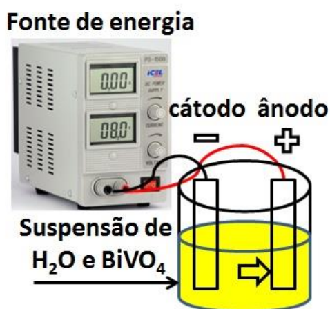
Figura I.3. Deposição eletroforética anódica do \text{BiVO}_4 (Fonte: próprio autor).
