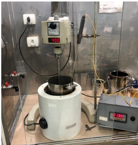
Figura 10 - Preparo das amostras com misturador mecânico, manta aquecida e controlador de temperatura.
