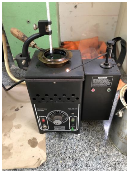
Figura 13 - Equipamento Ponto de Fulgor Vaso Aberto Cleveland 11341.
