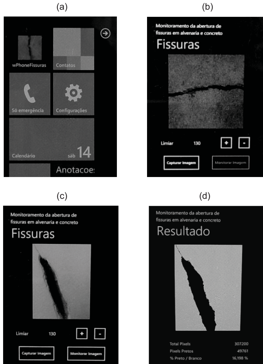
Figura 23 – Processamento de uma imagem de fissuras no aparelho celular com o sistema Windows Phone : (a) Seleção do sistema de captura de imagem a ser processada ( wPhoneFissuras ); (b) Seleção do sistema (tela inicial) e do limiar para o processamento da imagem a ser capturada; (c) Processamento (monitoramento) da imagem capturada; (d) Imagem binária da fissura e a apresentação do resultado dos pixels monitorados da imagem.
