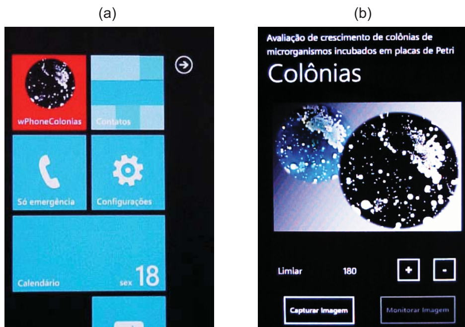
Figura 30 – Processamento de uma imagem da placa de Petri no aparelho celular com o sistema Windows Phone : (a) Tela inicial do aparelho celular com o ícone WphoneColonias ; (b) Seleção do sistema e do limiar para o processamento da imagem a ser capturada.
