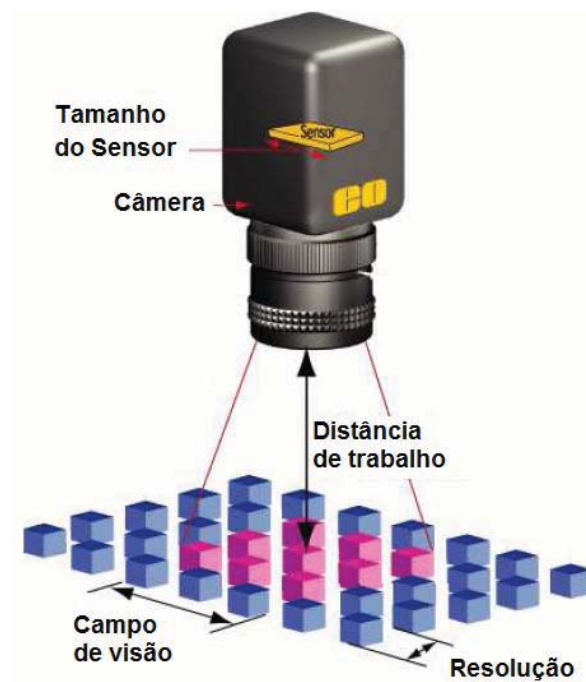
Figura 3 – Representação de uma câmera e sensor, com o parâmetro da distância de trabalho, o campo de visão e resolução.
