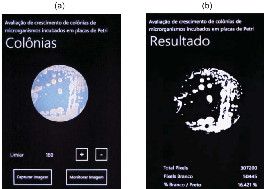
Figura 31 – Telas de processamento e monitoramento da imagem da placa de Petri. (a) Processamento (monitoramento) da imagem. (b) Imagem binária da placa de Petri e a apresentação do resultado dos pixels monitorados da imagem.
