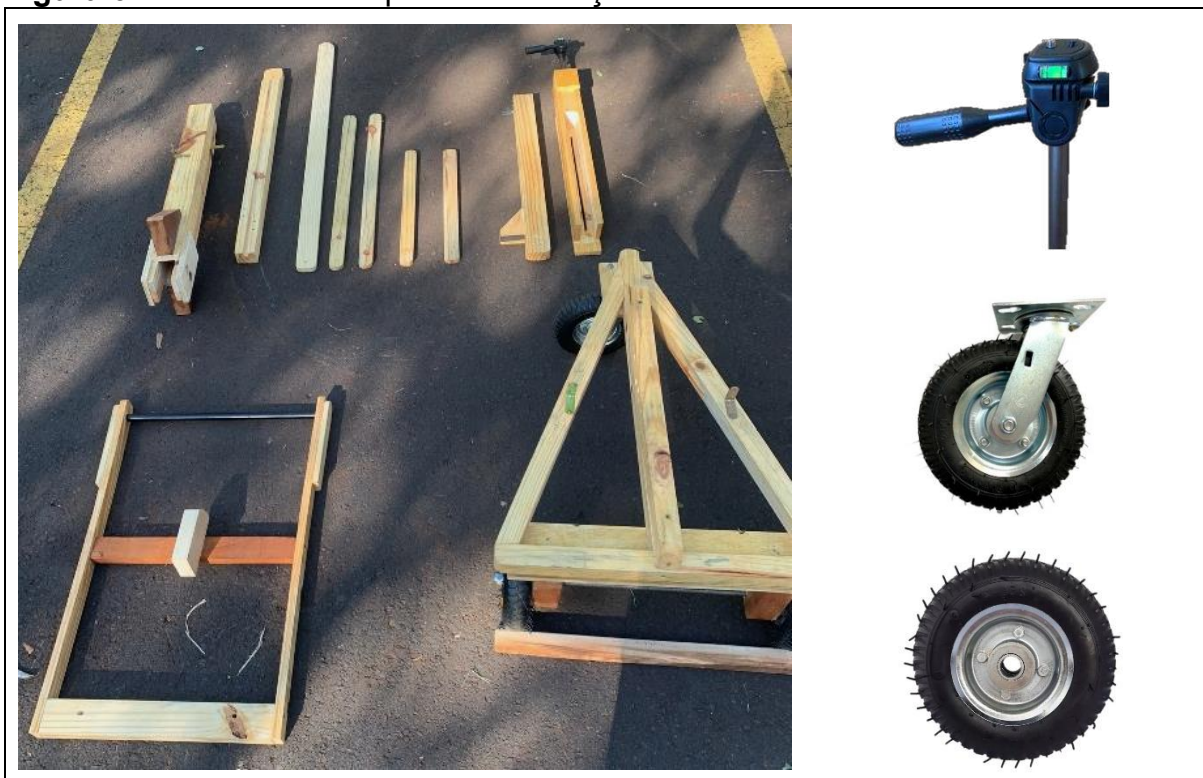
Figura 6 – Itens utilizados para a construção do VPAIPA
