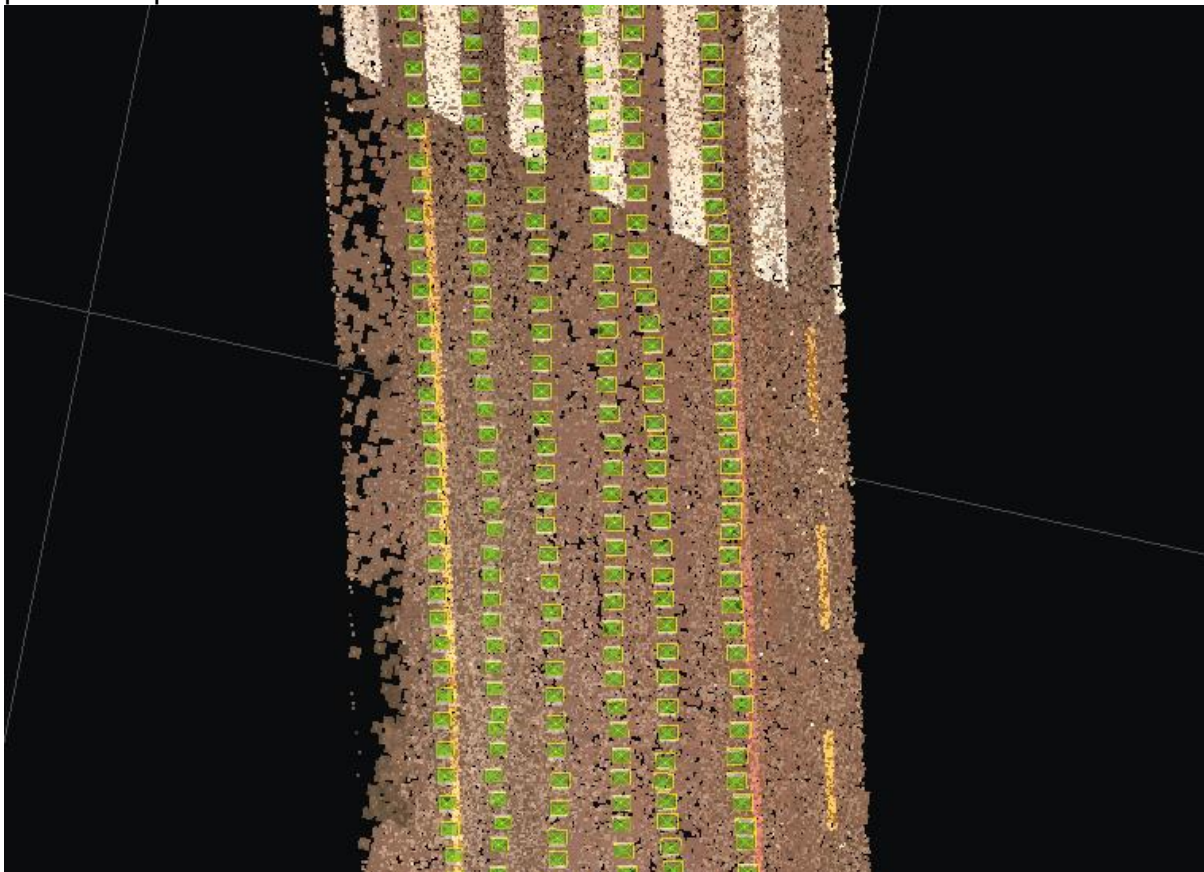
Figura 23 – Aerotriangulação com alinhamento longitudinal feito por marcação de pontos no pavimento
