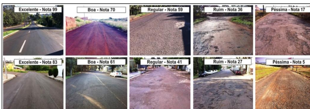
Figura 2 – Escala Visual Ajustada para avaliação da condição de pavimentos
