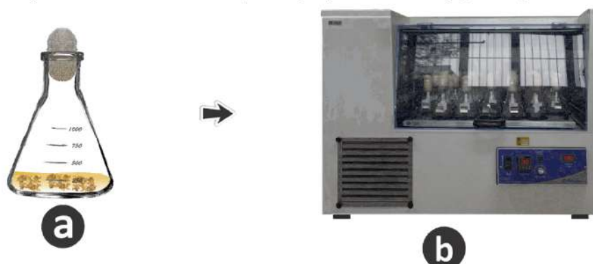
Figura 2 - Processo de fermentação por células imobilizadas em alginato de cálcio (figura 1a) em shaker orbital a 30 °C, 200 rpm por 120 horas (figura 2b)
