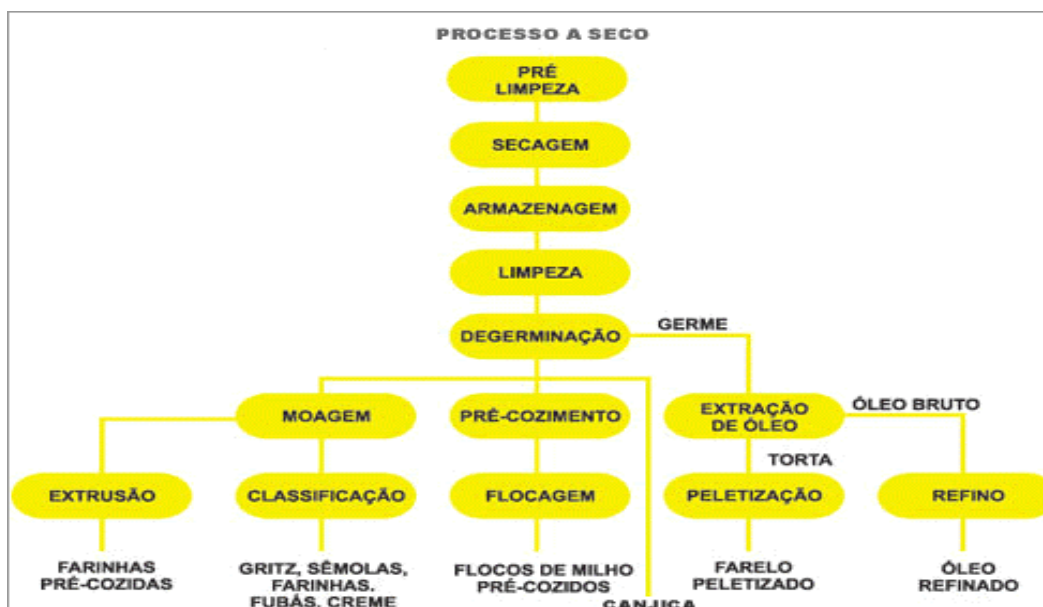
Figura II.7 - Esquema do processamento de milho a seco.
