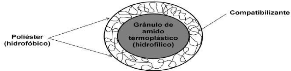
Figura 5 – Esquema da reação entre o amido termoplástico e poliéster na presença de compatibilizante
